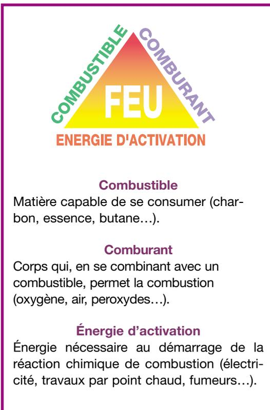
L'absence d'un des trois éléments empêche le déclenchement de la combustion.
